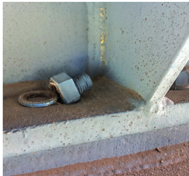
Obr. 3.141. Ustřížený šroub Fig. 3.141 Sheared bolt
