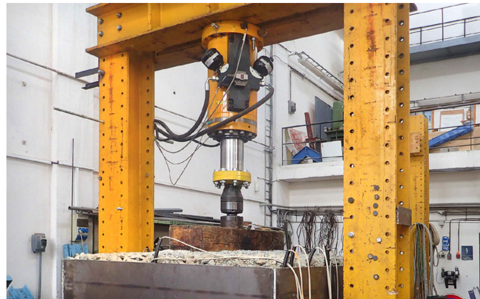
Obr. 3.17. Zkušební sestava se štěrkovým ložem a roznášecím prážcem Fig. 3.17 Test assembly with gravel bed and sleeper
