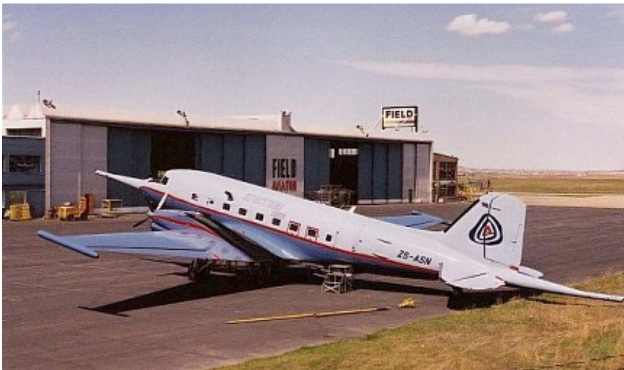
Basler Turbo BT-67 matrícula ZS-ASN en la versión para estudios geofísicos, meteorológicos y ambientales. Se aprecia claramente las sondas. Foto Basler
