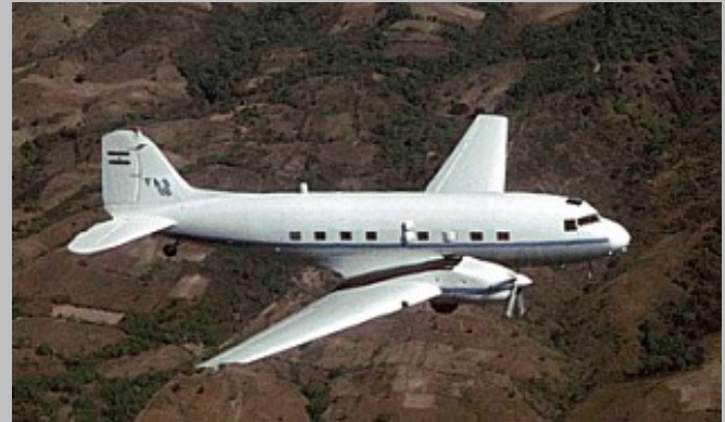
Basler Turbo BT-67 Fantasma matrícula FAS 116 de la Fuerza Aérea de El Salvador. Nótese las salidas de los extractores de humo en el fuselaje característica que lo identifica como "Gunship". Foto Basler
