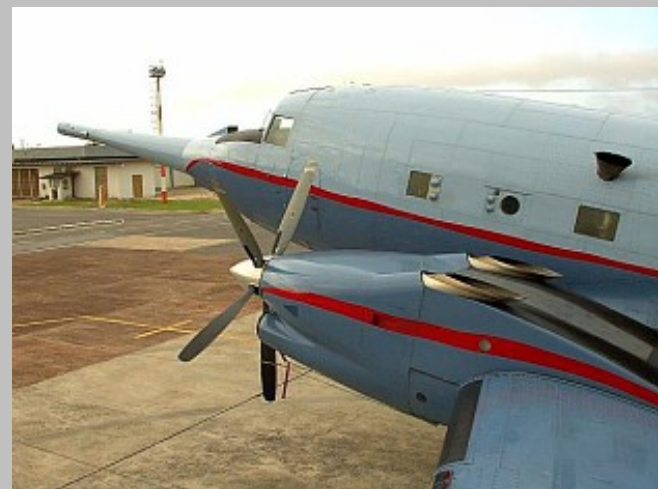
Detalle del Basler Turbo BT-67 matrícula ZS-ASN en la versión para estudios geofísicos, meteorológicos y ambientales. Se aprecia claramente la sonda en el morro. Foto Basler
