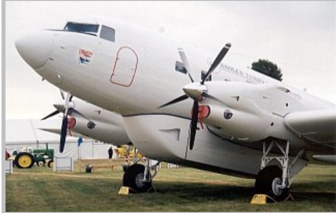
Detalle del Basler Turbo BT-67 en la versión "firebomber" o apagallamas. Se observa claramente el depósito para productos extintores. En esta fotografía se pueden apreciar la instalación motriz de los PT6A-67R certificados según FAR Parte 33 enmienda 10 y las hélices Hartzell de 5 palas certificadas según FAR Parte 36 cláusula III Foto Basler
