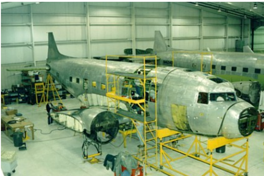
Fuselaje en proceso de conversión. Foto Basler
