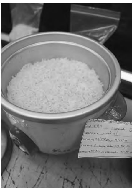
การตรวจสอบคุณภาพข้าวโดยการหุงเพื่อวัดอัตรา การไหลของแป้ง
