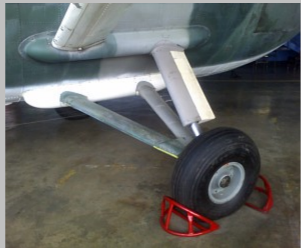
Detalle tren principal del Arava 201 EV-8014 en Caracas, May. 2006. Foto Autor.
