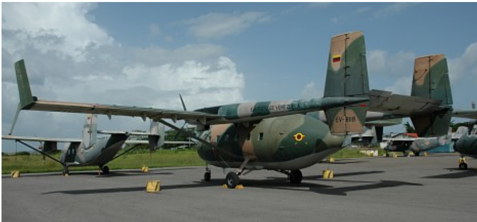
Arriba Arava 201 EV-8014. Nótese lo gastado de la pintura por las inclemencias atmosféricas. Abajo Arava 202 EV-8118 Nótese la aplicación de colores fuera de estándar. En algunos casos pueden existir cambios en el patrón de camuflaje y orden de los colores por retoques de mantenimiento. Ambas fotografías tomadas en Valle de la Pascua, Jul 2006. Foto Enver cuervos
